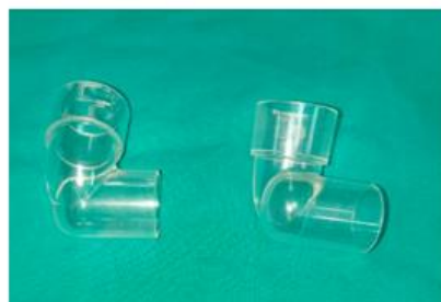
ตัดข้อต่อแยกกันเพื่อให้สามารถปรับระดับสูงต่ำและประระยะห่างให้พอดีกับช่องลมได้
