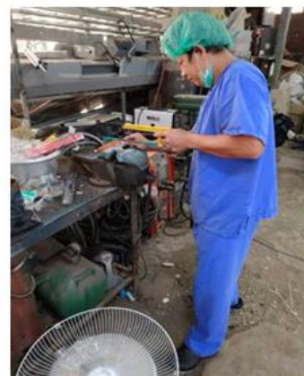
ตัดข้อต่อแยกกันเพื่อให้สามารถปรับระดับสูงต่ำและประระยะห่างให้พอดีกับช่องลมได้
