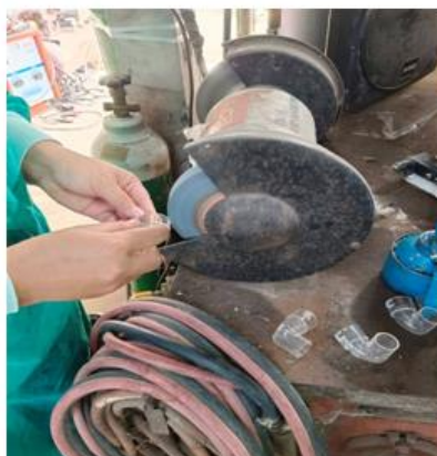
ตัดข้อต่อแยกกันเพื่อให้สามารถปรับระดับสูงต่ำและประระยะห่างให้พอดีกับช่องลมได้
